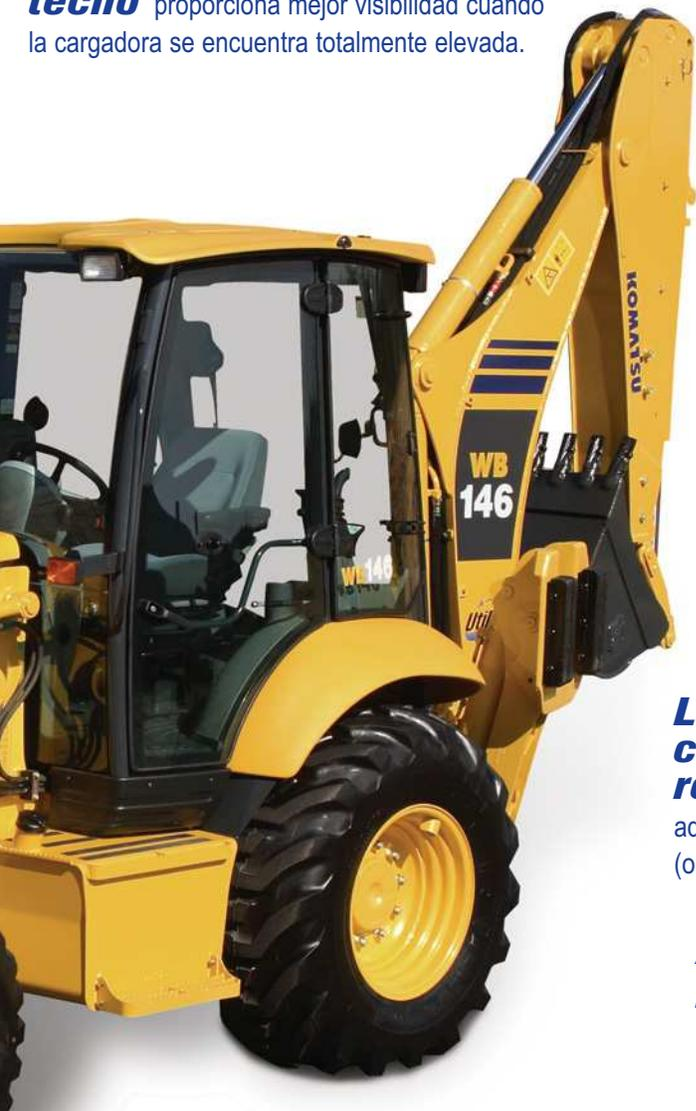
**La opción de brazo telescópico** aumenta la profundidad de excavación hasta 5533 mm (18 pies 2 pulgadas).
